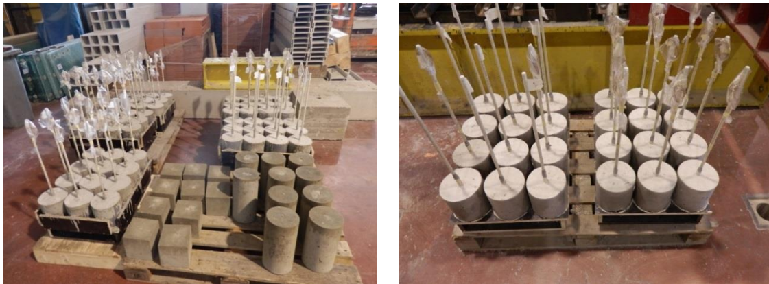
Figura 41 – Esquerda: todos os provetes realizados para os ensaios de arrancamento e de caracterização do betão; direita: provetes após descofragem.
