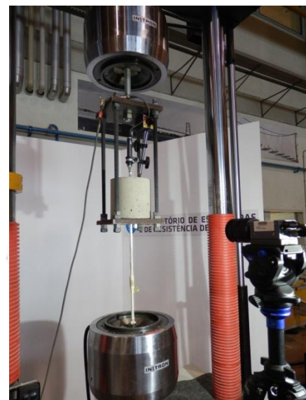
Figura 20 – À esquerda: representação de um esquema de ensaio de arrancamento [17]; à direita: esquema de ensaio de arrancamento
