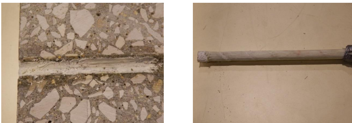
Figura 49 - À esquerda, provete seccionado longitudinalmente onde são visíveis grãos de areia resultantes do desgaste da superfície do varão; à direita, desgaste completo da camada de revestimento de areia do varão (exemplo do ensaio T60_5d_P2)
