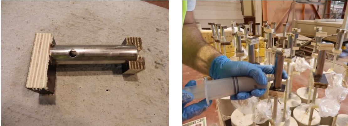
Figura 38 – esquerda: pormenor do tubo metálico; direita: injeção da resina que garante a aderência entre o tubo e o varão
